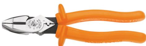
Estas pinzas de 9" con aislamiento de corte lateral para ponchar de Klein Tools brindan protección contra choques eléctricos de hasta 1000 voltios. Las pinzas son probadas individualmente para superar las normas IEC 60900 y ASTM F1505 de las herramientas con aislamiento, y marcadas claramente con el símbolo oficial de voltaje nominal de 1000 V. La estructura de acero forjado de estas pinzas ofrece máxima resistencia, y la matriz ponchadora proporciona mayor apalancamiento.
