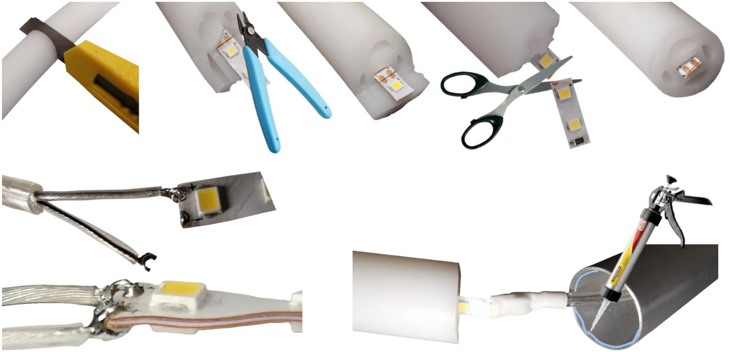
Para uso en exteriores se debe sellar cada unión y extremo de la tira con silicón Downcornering o similar para evitar las filtraciones de humedad. Los empalmes en exterior deben aislarse con el método de aislamiento hermético.
