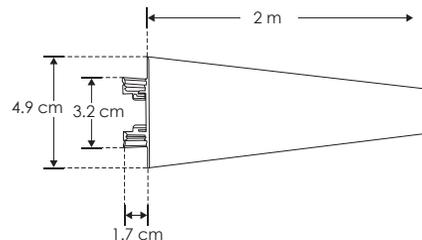
**Material** Kit de perfil de aluminio acabado natural de sobreponer con 2 salidas de luz de 2 m de largo, para recibir tira extraplana de LEDs
