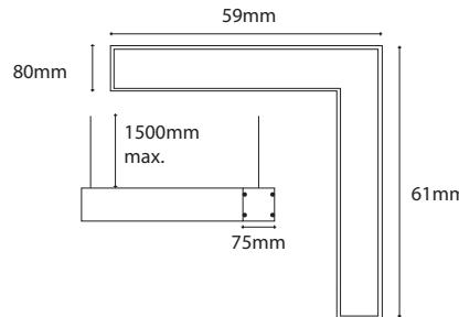
**Luminario en esquina para suspender,** fabricado en aluminio con reflector de aluminio y difusor de acrílico opalino. Acabado en blanco o negro.
