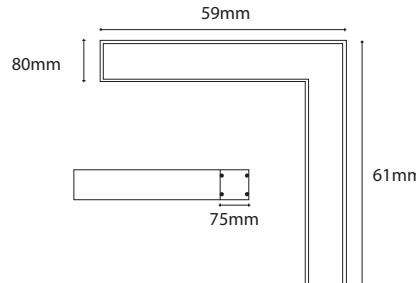
**Luminario en esquina para sobreponer,** fabricado en aluminio con reflector de aluminio y difusor de acrílico opalino. Acabado en blanco o negro.
