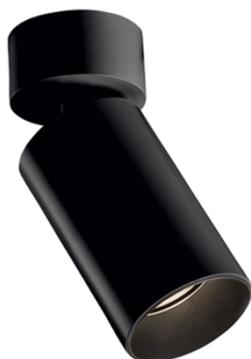
Proyector cánopo, para sobreponer en techo o muro, con cuerpo de Aluminio acabado color negro, Led 7.5W, 3000K 33° para interior.
