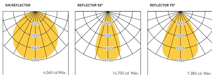
5.1 EFICIENCIA DEL SISTEMA: 111 lm/W (sin reflector)
