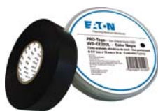
WD-CE33UL Cinta eléctrica de PVC para aislamiento hasta 600 V Máximo de Temp. 105°C (1 hr max.) 18m x 20mm Auto extingible Disponibles en color: Negro
