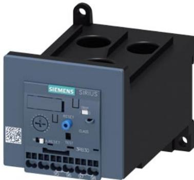
Relé de sobrecarga 12,5...50 A electrónico para protección de motores tamaño S3, clase 10E instalación independiente Circuito principal: Transformador con primario pasante circuito auxiliar: borne de resorte Rearme manual/automático
