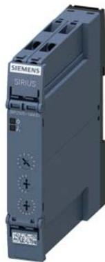
relé temporizador, multifunción 1 comutado, 13 funciones 7 rangos de tiempo (0,05 s...100 h) AC/DC 12...240 V con AC 50/60 Hz con LED, borne de tornillo
