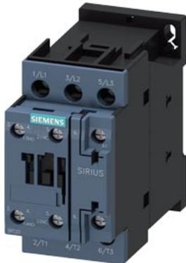
contactor de potencia, AC-3e/AC-3, 25 A, 11 kW/400 V, tripolar, 400 V AC, 50 Hz / 400-440 V, 60 Hz, contactos auxiliares: 1 NA + 1 NC, borne de tornillo, tamaño: S0
