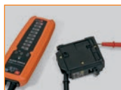
Comprueba la Continuidad del Interruptor
